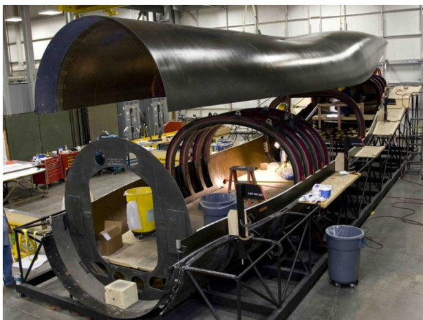
Fuselagem com estrutura monocoque.
