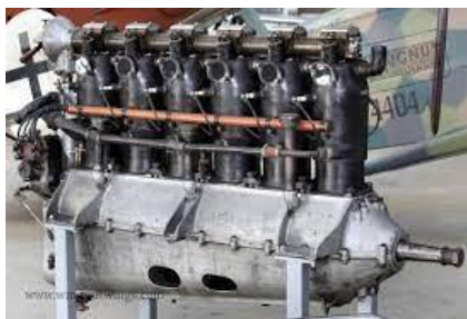
Motor Mercedes D.III, que foi usado no Fokker VII.
