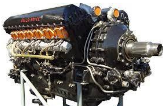
Motor Merlin V-12, tipo que foi usado no caça Spitfire e no bombardeiro Lancaster .
